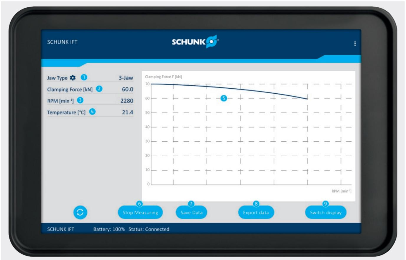
Eine sehr nutzerfreundliche Bedienoberfläche ermöglicht jedem Anwender eine intuitive Bedienung des Spannkraftmessgerätes. Je nach Anwendungsfall bietet die App eine optional angepasste Oberfläche. Ein Beispiel hierfür ist das hochauflösende Spannkraft-Drehzahl-Diagramm bei dynamischer Spannkraftmessung.
