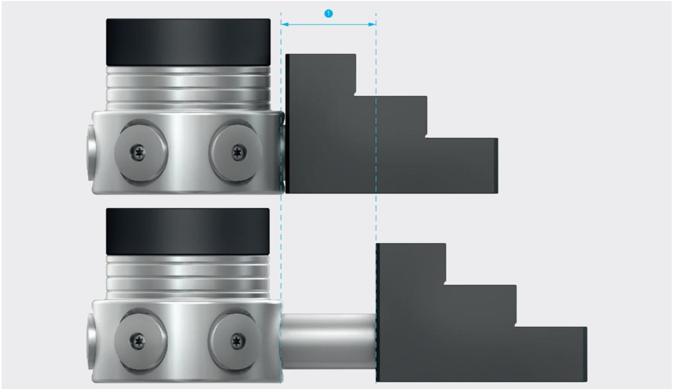
Mit dem neuen Messkopf kann ein großer Spannbereich des Spannmittels abgedeckt werden. Je nach Spannmittelgröße kann der Spannbereich über Verlängerungen individuell angepasst werden. Im Standard können drei Spanndurchmesser eingestellt werden. Eine Schraubenverbindung zwischen Messkopf und Verlängerung sorgt für einen schnellen und sicheren Wechsel.
