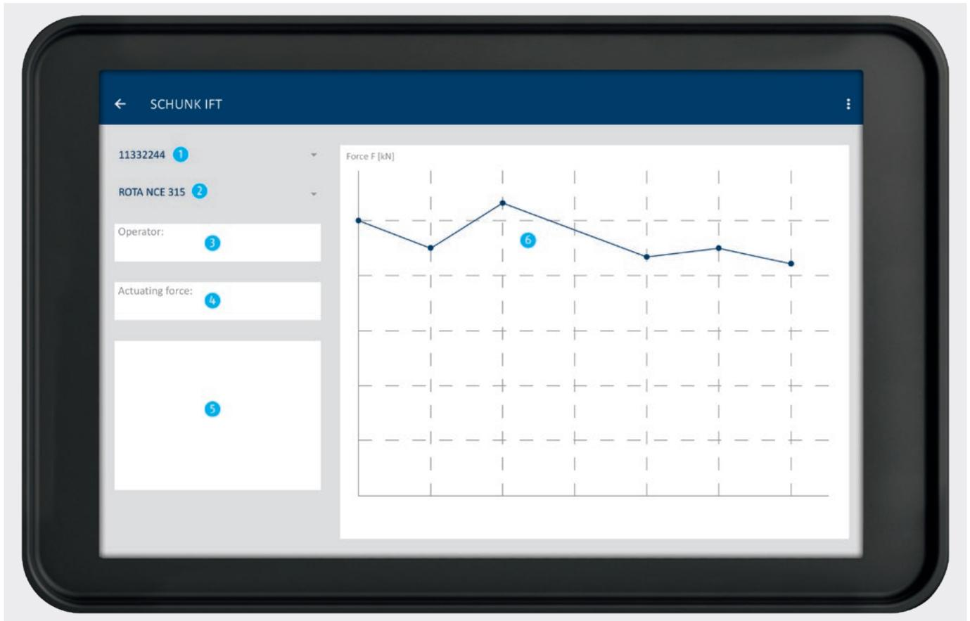
Die integrierte Datenbank ermöglicht den Zugriff auf gespeicherte Messwerte. Jedes Spannmittel wird maschinenbezogen hinterlegt. Dadurch können zu jedem Zeitpunkt die Messwerte über die App visualisiert werden. Vorteil: Historie des Spannmittels kann direkt und ohne weiteres Equipment eingesehen werden. Der Verlauf der Spannkraft gibt Aufschluss darüber, in welchem Wartungszustand sich das Spannmittel befindet.
