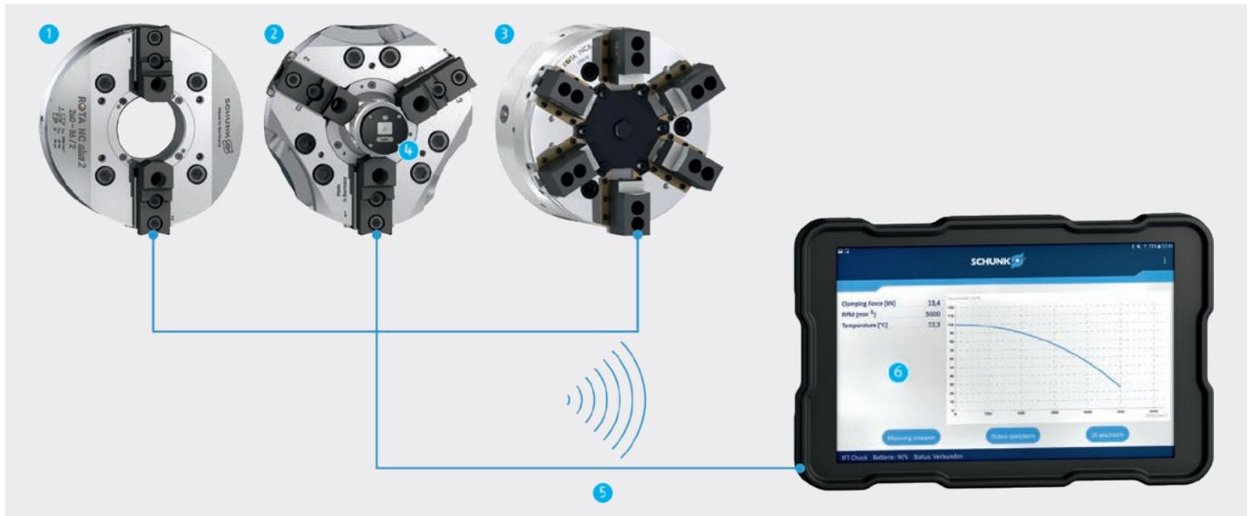
Mit dem Messkopf IFT-M1 können Spannkräfte bei 2-, 3- und 6-Backenfuttern schnell und hochgenau gemessen werden. Die Messwerte werden vom Messkopf drahtlos an ein Industrie-Tablet übertragen und dort in einer App angezeigt. In der integrierten Datenbank können die Messwerte maschinen- und futterbezogen gespeichert werden. Diese können dann jederzeit, zum Beispiel im Falle von Wartungen, wieder aufgerufen werden.
